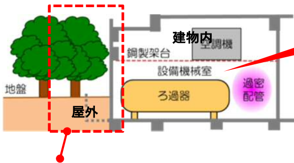
ろ過器等の設置の断面
